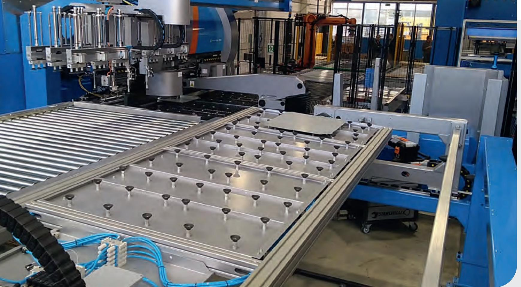
Das bei Schulthess installierte automatische Biegesystem besteht aus einer servoelektrischen Blechbiegemaschine EBe4FM, einer Abkantpresse eP0520, einem auf Schienen gleitenden 7-achsigen Industrieroboter und einem palettierten Förderbereich mit automatischer Palettenzuführung. Hier wird ein Teil von der Biegewendevorrichtung der EBe zur Zentrierung auf der Picking & Centering Device umgedreht.
