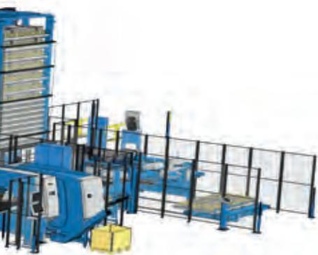
Das große Night Train System automatisiert das Material und Informationssysteme des Schneidens und Stanzvorgänge der Fabrik und kombiniert individuell Fertigungsschritte in ein Prozess. Es verfügt über 400 Schubladen.
