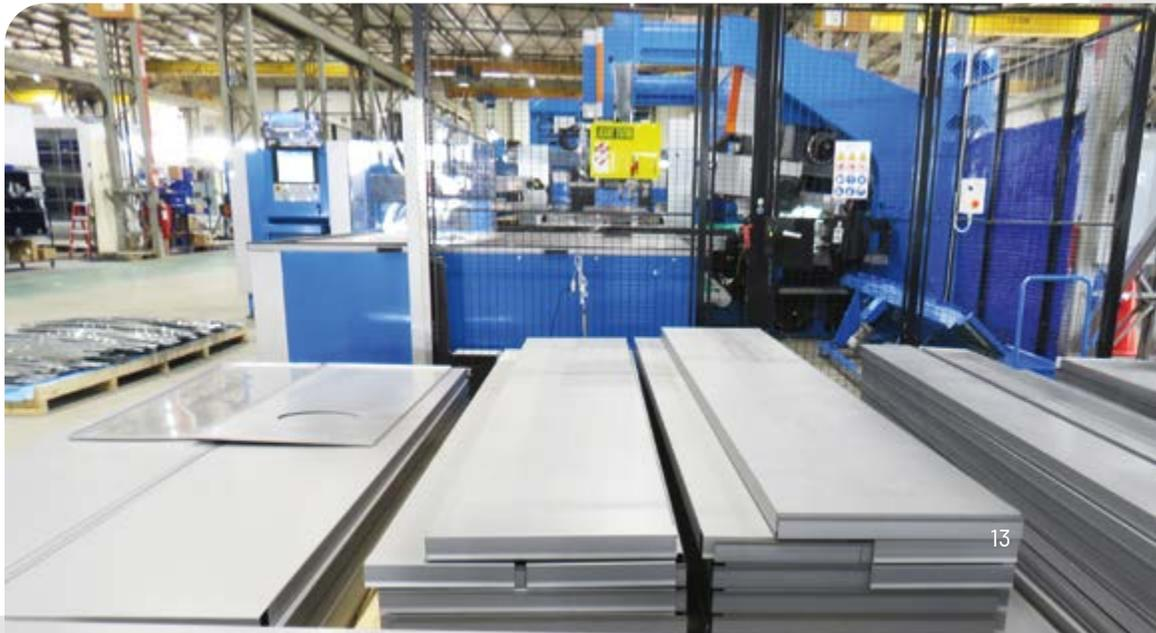
Die Prima Power PSBB ist ein kompaktes flexibles Fertigungssystem, das einen direkten Fluss vom Stanzen/Scheren zur Biegezone ermöglicht.
