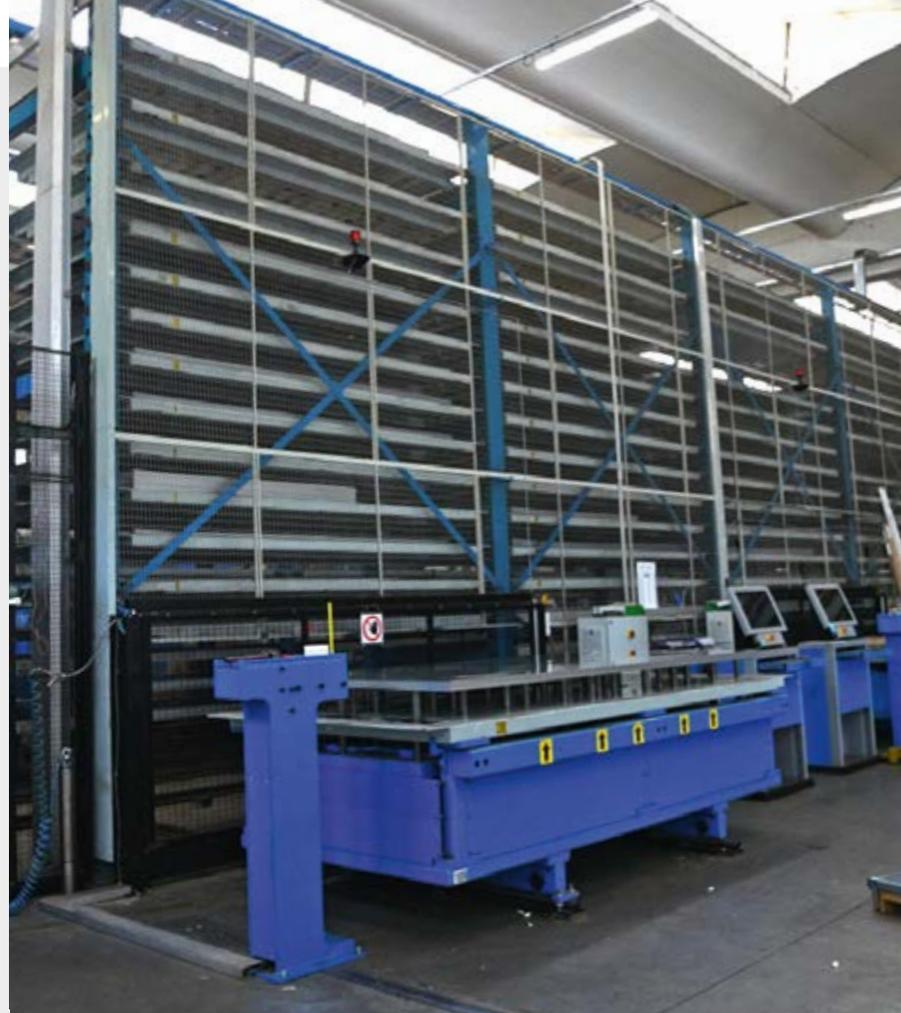
Das automatische Lagersystem von Rizzato wurde in 20 Jahren zweimal modernisiert und erweitert und ist derzeit mit fünf Schneidemaschinen von Prima Power verbunden.
